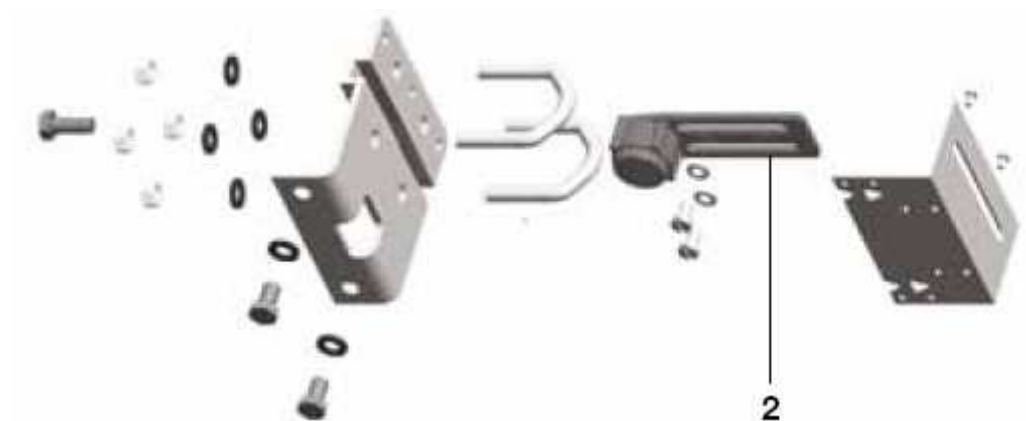
Rys. 4 Zestaw do montażu na siłowniku liniowym, kolumnowym
