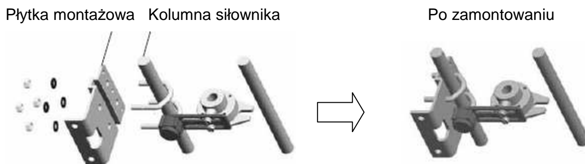
Rys. 9 Montaż płytki na siłowniku kolumnowym
